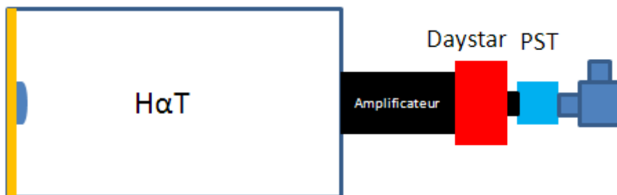
Double stack Daystar + PST. Le BF n'est pas nécessaire dans ce cas.
